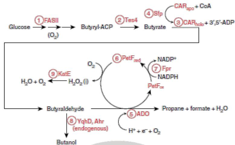
**Fig. 1.** Représentation de la production de biopropane à l'aide de l'E. coli BL21 [6]
