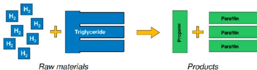
**Fig. 3.** Approche simplifiée de réduction (hydrogénation catalytique) des lipides pour en produire des alcanes (paraffines) ainsi que du biopropane comme sous-produit d'hydrogénation du glycérol (tiré de [10])
